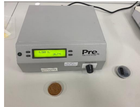
วิเคราะห์ a_w ด้วยเครื่องวัดค่า a_w
